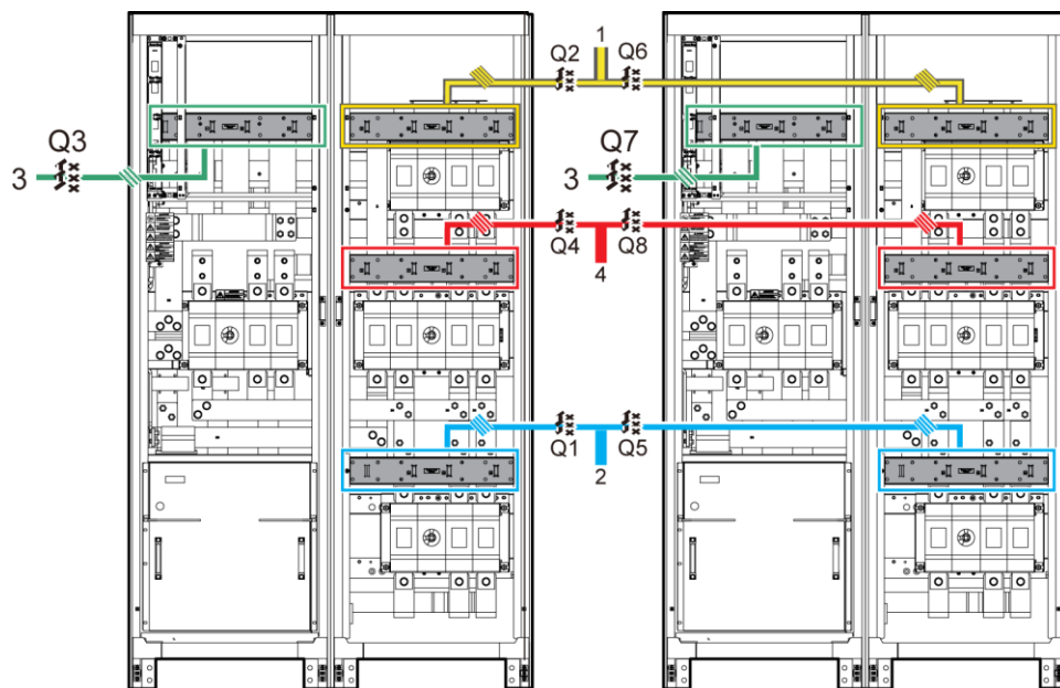
图3-71 1+1 并机系统接线示意图（800kVA）
