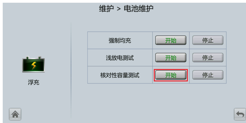
图5-23 开始核对性容量测试
