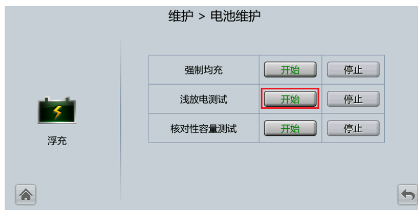
图5-22 开始浅放电测试
